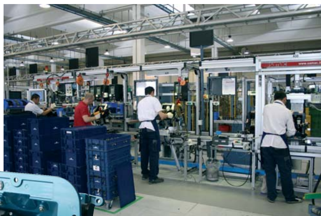
La pedaliera per autocarro assemblata nell'impianto progettato e costruito da Samac.
