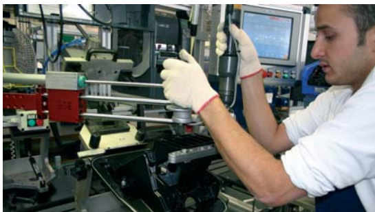
Unità di avvitatura, con controlli di coppia, angolo, posizione e sequenza della linea per l'assemblaggio della pedaliera per autocarro.
