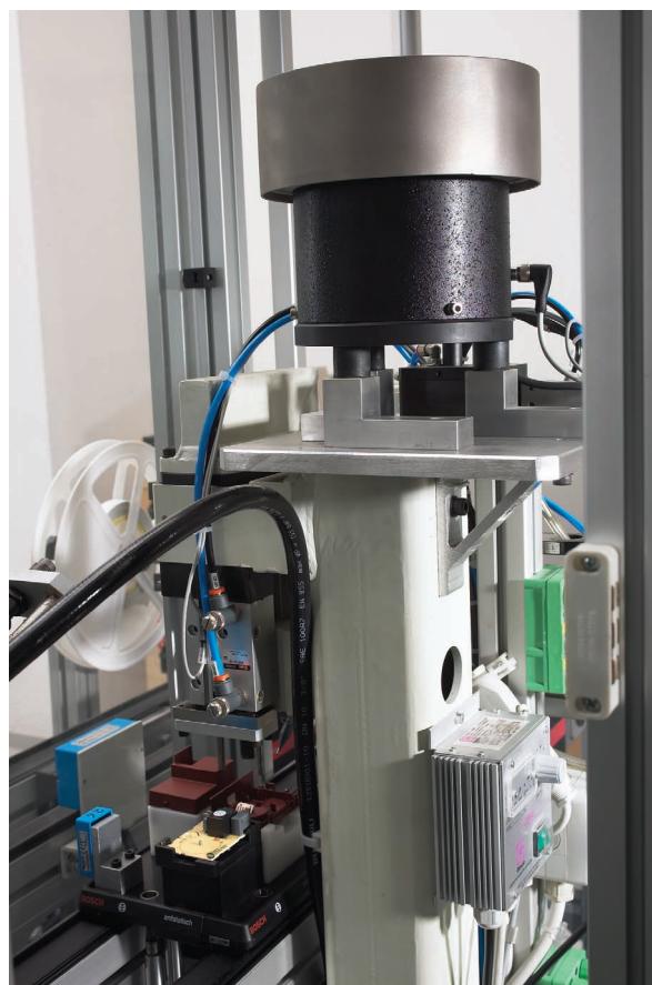
Stazione di alimentazione e carico sfera nel rotore.
