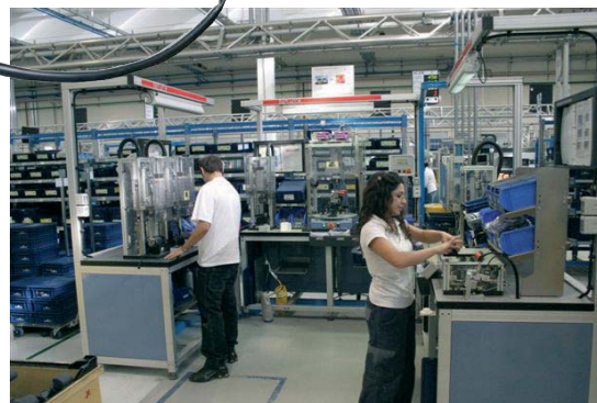
Il distributore pneumatico per sistema frenante di autocarro assemblato sulla linea Samac.
