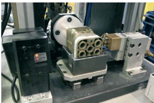
Una fase di verifica del modello corretto di corpo inferiore tramite tastatori e barcone nella linea di assemblaggio dei distributori pneumatici.
